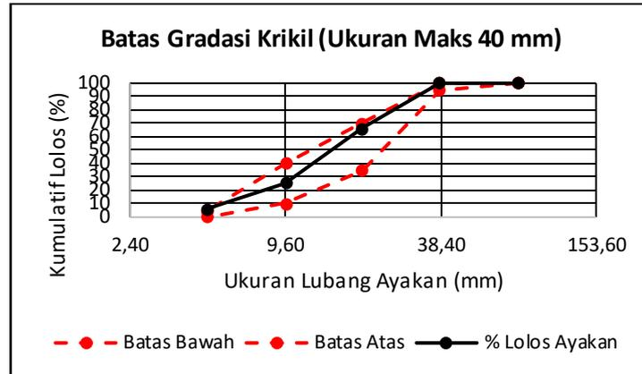
Gambar 2. Gradasi analisa ayakan agregat kasar batu kapur
