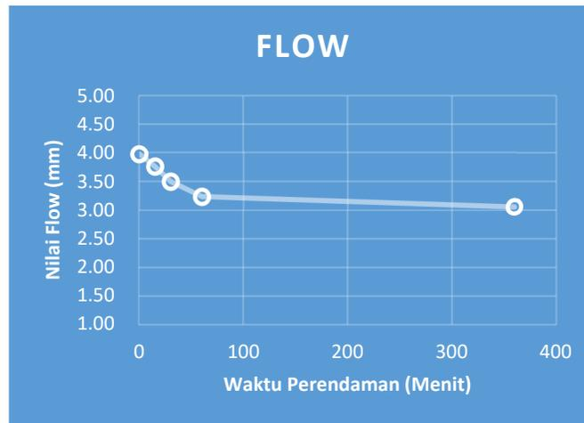
Gambar 3. Hubungan nilai Flow dengan Waktu Perendaman
