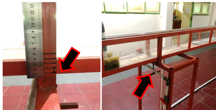
Gambar 2. Tuas pengatur kemiringan saluran
